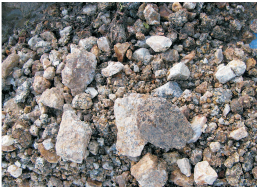
FOTO 5, 6 : detail jádra vrtu J4 v metráži 7 - 9 m - zastižen úlomkovitý štěrk s úlomky a kameny granitu
