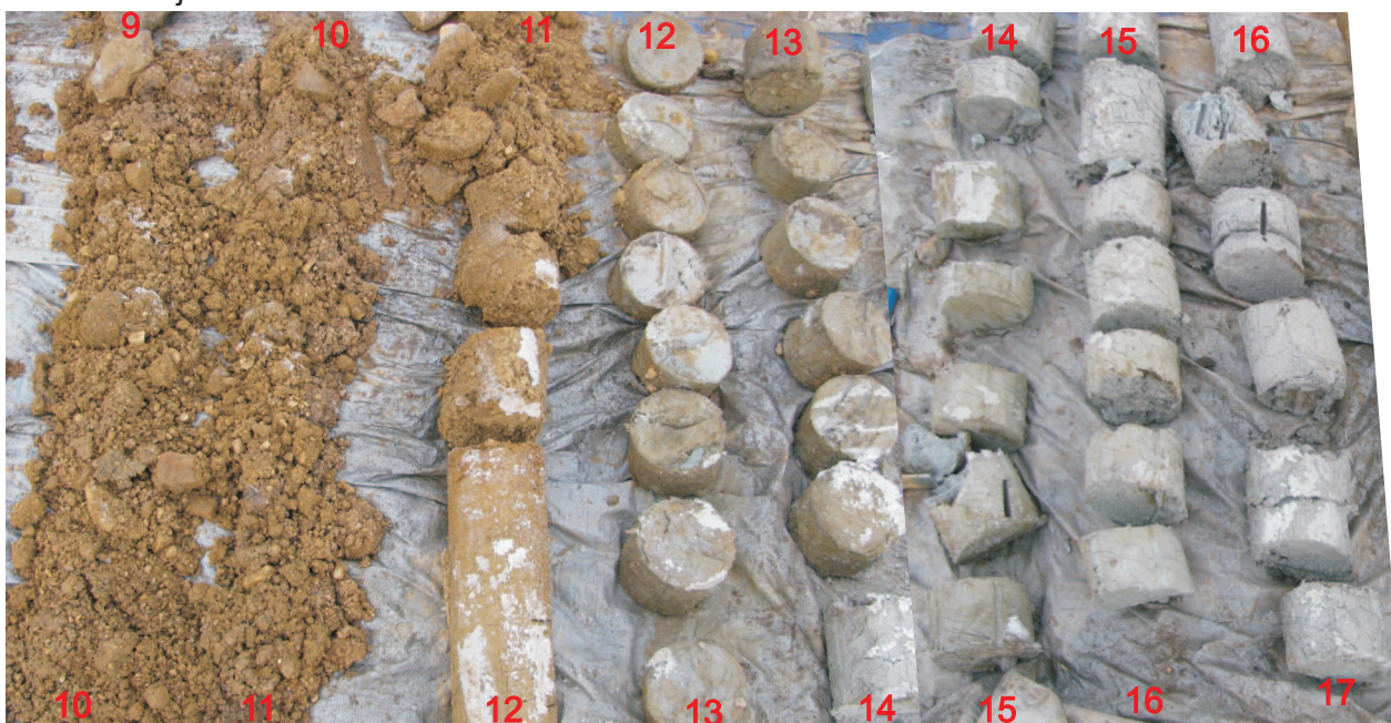
FOTO 11: vyvrtané jádro vrtu J1 v metrži 10 - 17 m
