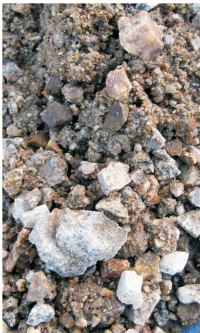
FOTO 5, 6 : detail jádra vrtu J4 v metráži 7 - 9 m - zastižen úlomkovitý štěrk s úlomky a kameny granitu
