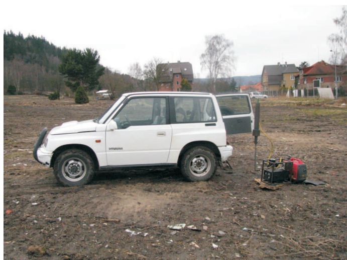
FOTO 20 : penetrační sonda DP6
