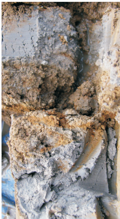
FOTO 7 : báze vrtu J4 - přechod do terciárního tufitického jílu
