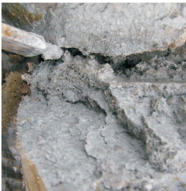
FOTO 12: detail báze vrtu J1 - terciární tufitický jíl
